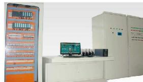
1、系统有控制柜、操作台、工控机、传感器、通讯模块和仪表等组成;
